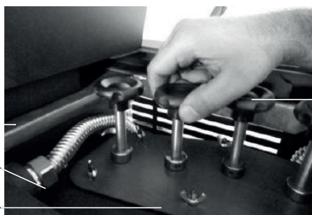
Foyer - Nettoyage manuel de l'échangeur
